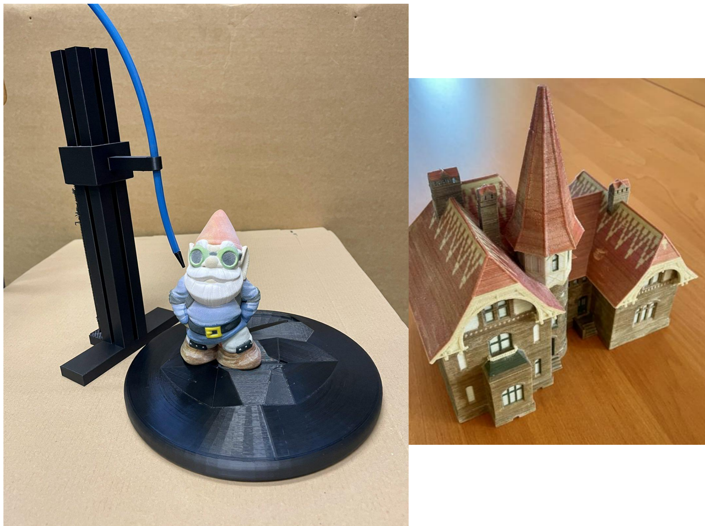
Rys. 1 Profesjonalne stanowisko do utrwalania wydruków gipsowych (z lewej) i przykład wydruku.
