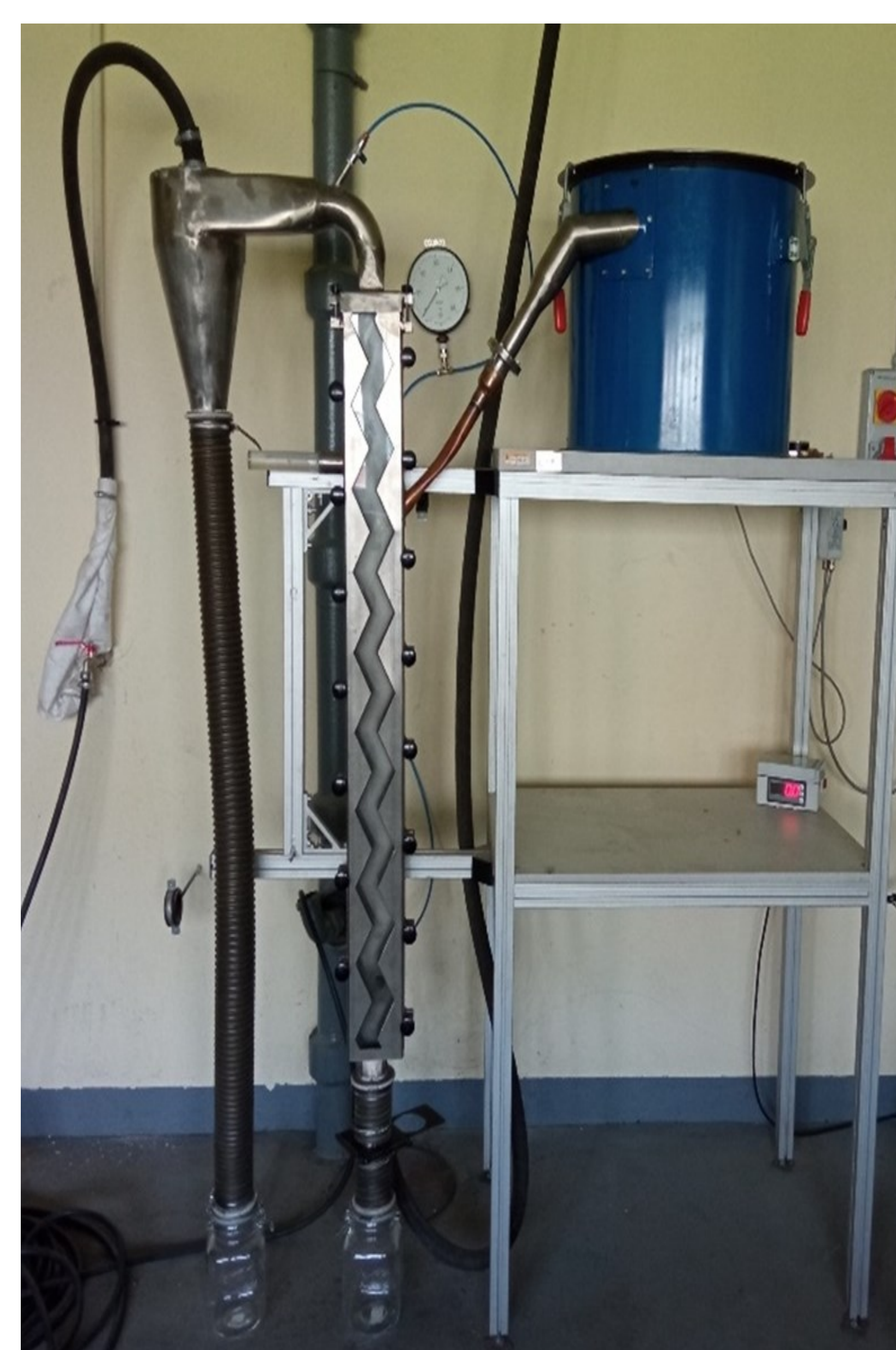
Rysunek 8. Separator powietrzno-zakosowy, typu „zig-zag”
