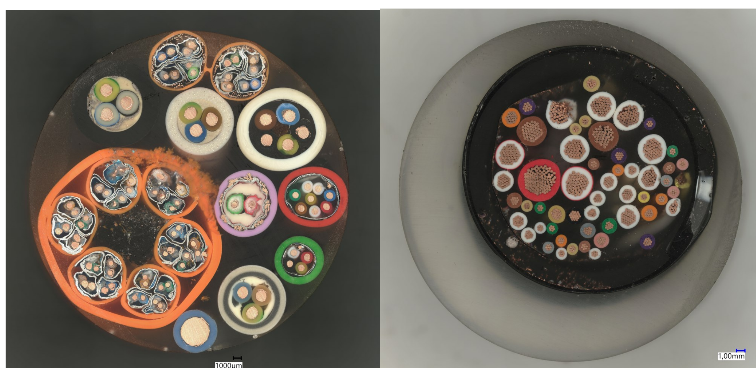
Rysunek 2. Przykładowe przekroje badanych kabli elektro-energetycznych
